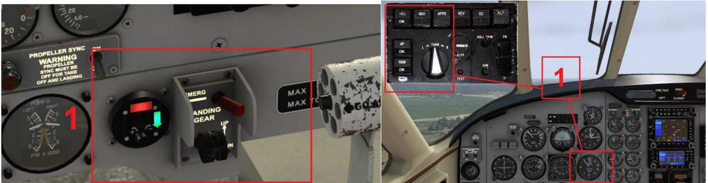
2. REALIZAMOS LA PRIMERA REDUCCIÓN DE POTENCIA Y **RETRAEMOS FLAPS**. REDUCIMOS RPM HÉLICES AL 91%
